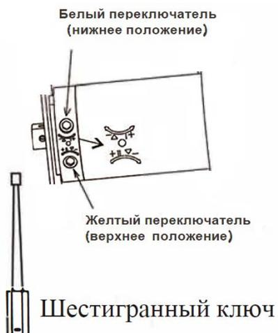
Положения автоматической остановки (положения, в которых мотор останавливается при выдвигании и при сворачивании) можно регулировать по мере необходимости. Концевые положения предустановлены на заводе и в большинстве ситуаций не нуждаются в дополнительной регулировке.
